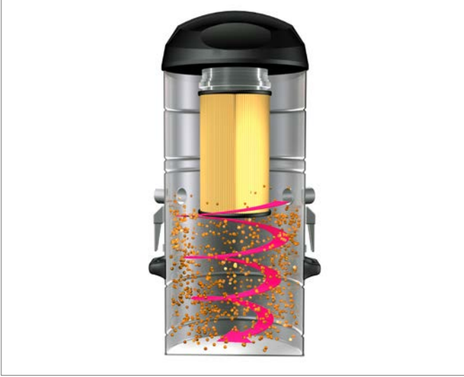
Şek. 2-2 Siklon tutucu filtreleme prensibine göre filtreleme
