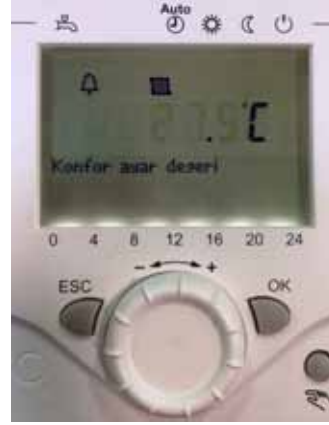
Şekil 3. İsteddiğiniz sıcaklığa geldiğinizde OK tuşuna basınız.
